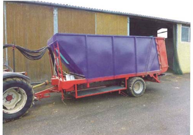
Hobelspäneverteilwagen zum Verteilen und Nachstreuen von Hobelspänen.
