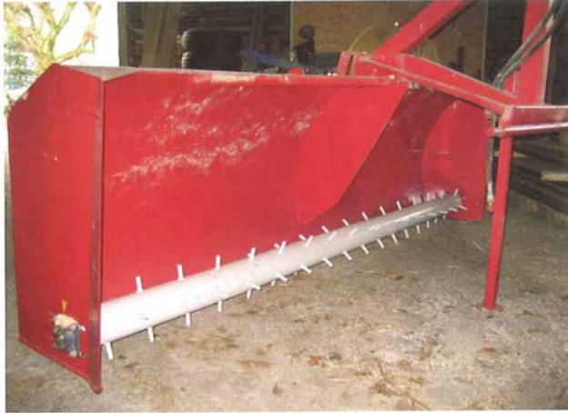
Späneschild zum Verteilen von Hobelspänen vor Belegung des Stalles.
